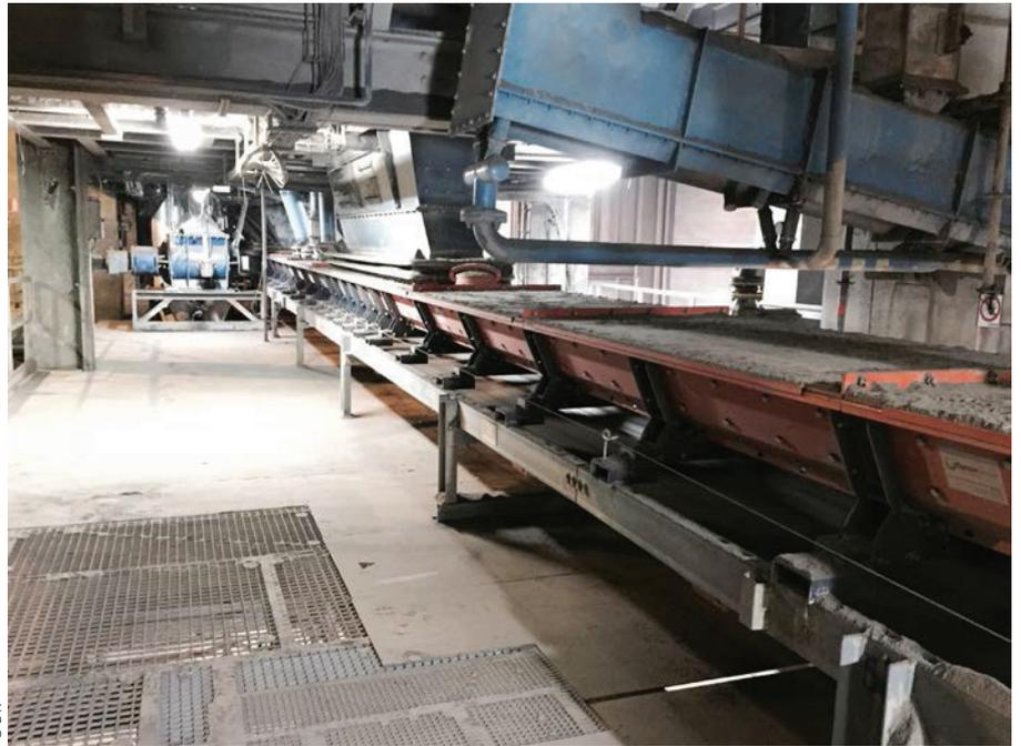
→ Le transport du cru a lieu vers le four grâce aux convoyeurs. Le cru est un mélange de poudre de calcaire et d'argile qui est cuit à une température de 1 450 °C. Ce procédé aboutit à la clinkérisation.
