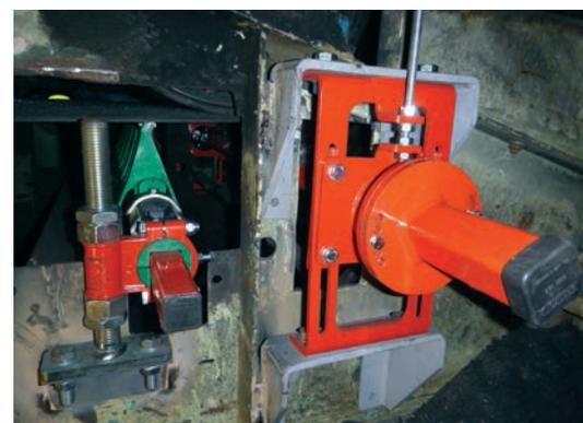
→ Des racleurs primaire et secondaire OFC-Brelko. Ils intègrent des supports de lames en nylon avec 33 % de fibres de verre.
